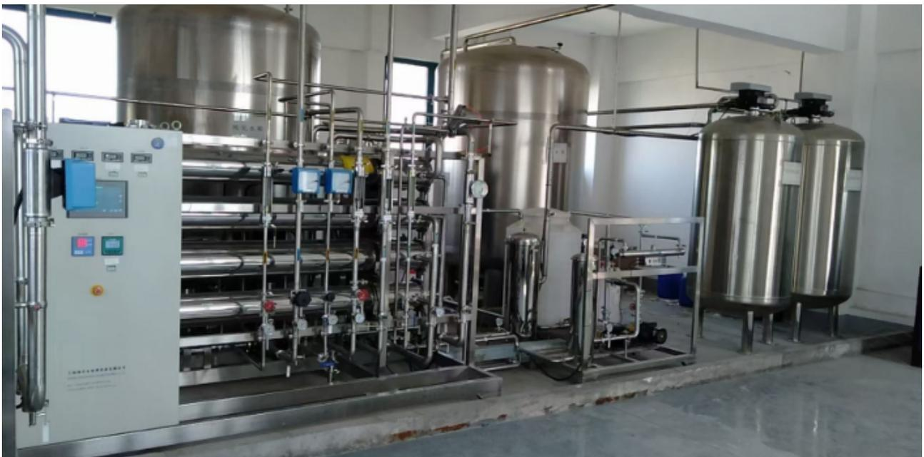
如何选购药纯化水设备：药纯化水设备的在控制方式上，制药纯化水设备有全自动化控制和半自动化控制两种类型。其中，全自动化控制是目前制药行业应用较为普遍的一种控制工艺。通过全自动化控制，可有效提升管理效率，降低因人误操作而造成设备故障发生率，同时，一定程度上也会减少设备管理员的工作量。而半自动化控制通常是系统整体全自动化，而预处理系统需人工操作，比如活性炭过滤器、软化器、多介质过滤器需手动控制阀进行定期冲洗、反冲洗，其他方面则不变。制药纯化水设备的安装环境要求，制药纯化水设备对安装环境有严格要求，设备应尽量安装在通风良好的室内空间，有稳定的电源和充足的水源，无腐蚀性化学品，地面应平整，地基承重根据设备而定。另外，注意纯水设备摆放处要设有排水沟等。
